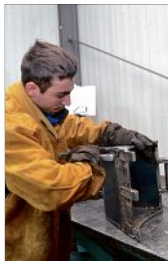
**ATELIER SOUDURE.** La fabrication d'un godet pour micro-engins.
